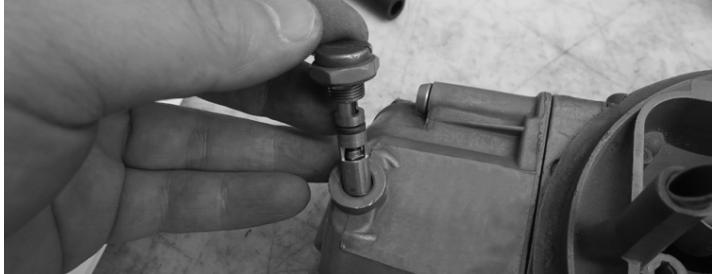
6. À l'aide d'un tournevis à tête plate, retirez les vis de mélange de ralenti de l'unité de mesure primaire, tirez les petits joints toriques en liège et jetez-les.
