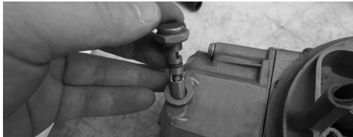
6. Con un destornillador plano, retire los tornillos de la mezcla de velocidad mínima del bloque de medición primario, saque las pequeñas juntas tóricas de corcho y deseche las.
