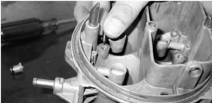
9. Limpie cuidadosamente todas las piezas con un solvente de limpieza o adelgazador para laca que sea adecuado. Asegúrese de quitar todo el residuo de las juntas del carburador, bloques de medición y recipientes de combustible. Asegúrese de limpiar todos los depósitos de carbón en los orificios internos y pasajes del estrangulador.
